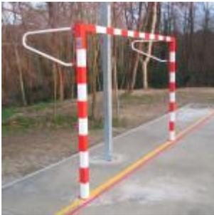
Portería de balonmano y fútbol sala reglamentaria en aluminio fija de medidas 3x2m, fabricada según norma UNE EN749: 1995 + AI:1998. Palos de 8x8cm, orejas metálicas, ganchos de plástico antilesión y estructura color rojo con adhesivos color blanco. No incluye redes. Se incluye anclajes.
