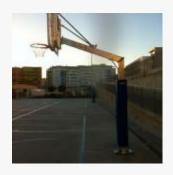
Canasta de básquet fija de doble platina con salida de 1,65m. Poste principal en tubo cuadrado 100 x 150mm y 2mm de grosor. Reforzada en la base y fabricada en dos partes.
